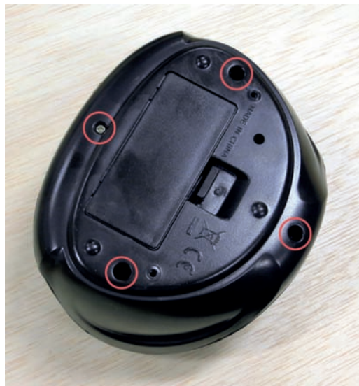
Rysunek 7.5. W celu otwarcia obudowy zegara należy odkręcić wszystkie cztery śruby oznaczone kółkami
